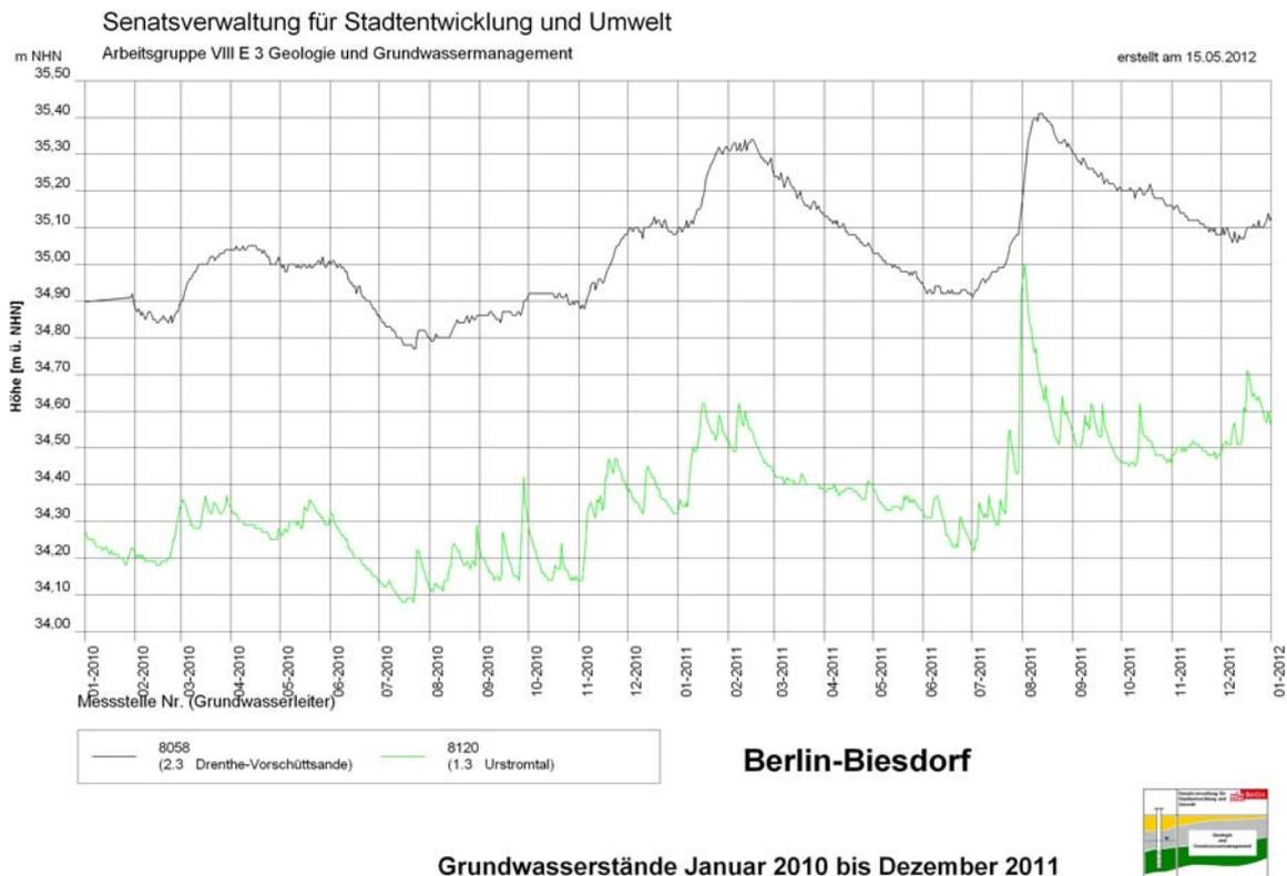
Abb. 1 Grundwasserstandsganglinien der Messstellen 8058 und 8120
